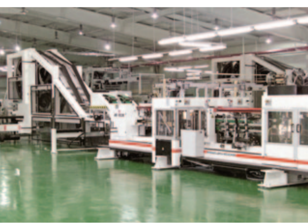
Highlight tecnologico della nuova linea di sacchi in carta presso la Kumpoong Co. Ltd. – la fondellatrice-CNC AD 8330.
