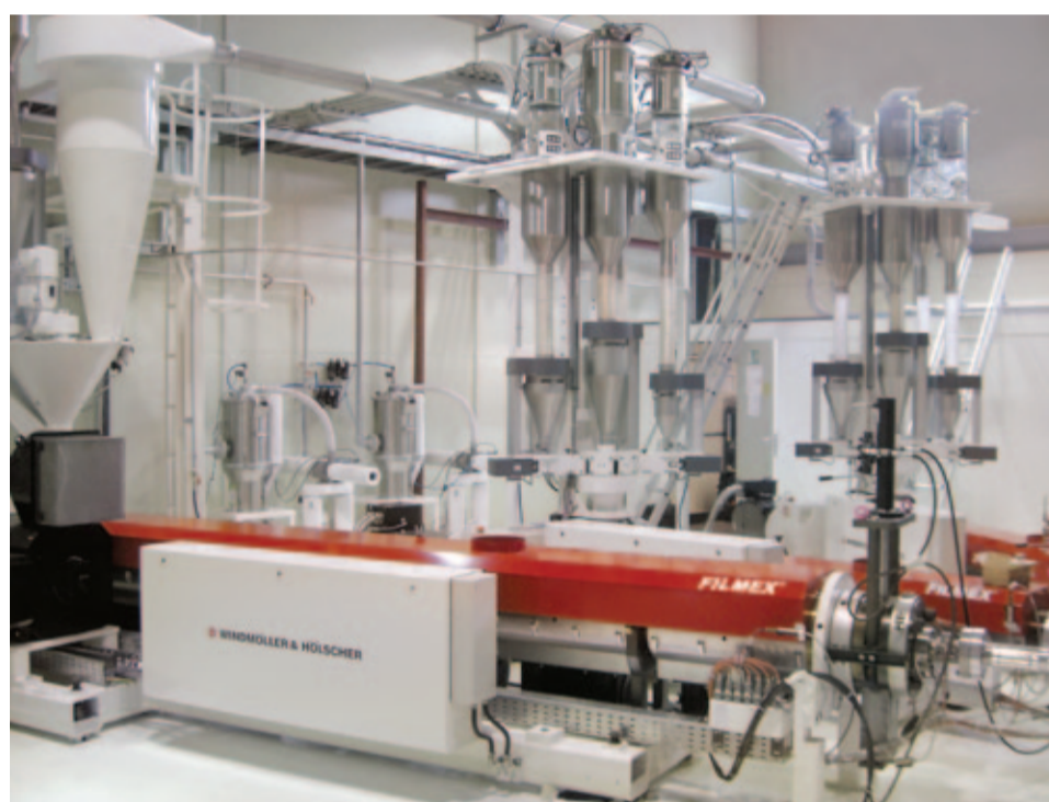
Il FILMEX per CPP e film barriera presso la Sammin Chemical è equipaggiato con 3 estrusori.
